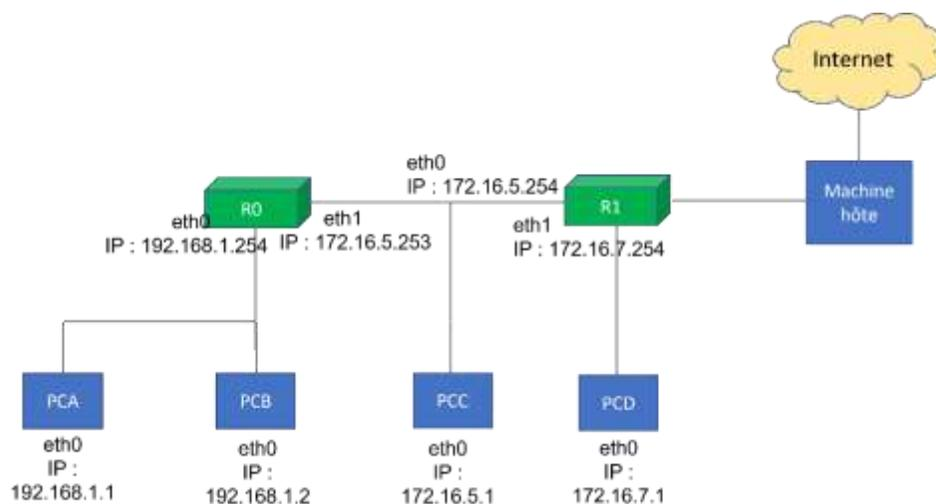
2. Pour connecter le routeur R1 et la machine hôte, nous aurons besoin qu'un pont (bridge) soit établi entre les deux. Modifiez le fichier de configuration du lab (lab.conf) pour ajouter la commande `r1[bridged] = true`.
