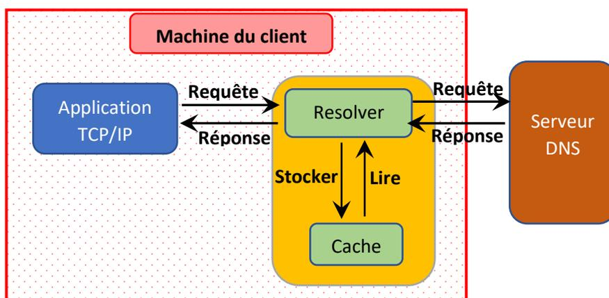
Dans l'illustration ci-dessus on voit l'interaction entre la machine du client et celle du serveur. Sur la machine du client, l'application TCP/IP fait premièrement sa requête vers le resolver. Le resolver cherche premièrement dans son cache pour savoir si une valeur existe déjà pour l'adresse ou le domaine cherché. Si cette valeur n'existe pas, le resolver contacte le serveur DNS.
