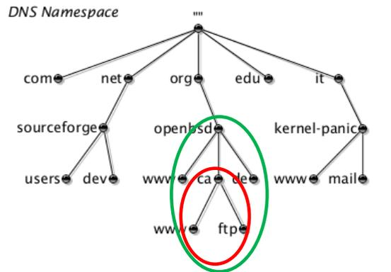
Dans l'exemple ci-dessus (**Source : kernel-panic.it**) on se concentre sur un sous-arbre sur 6 niveaux (y compris la racine). On peut distinguer par exemple un sous-domaine **ca.openbsd.org**, et un sous-domaine plus grand au nom de **openbsd.org**.
